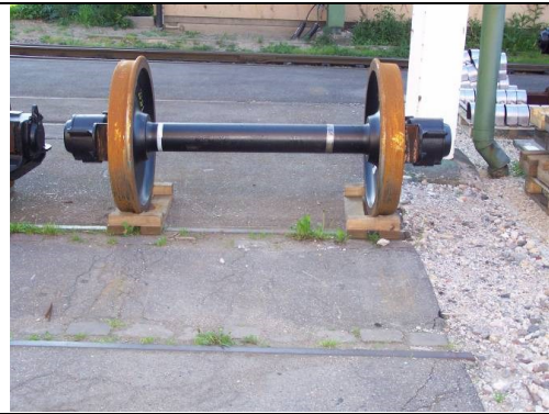
Bild 6: Einzellagerung mittels Ladegestell für Einzelradsätze
