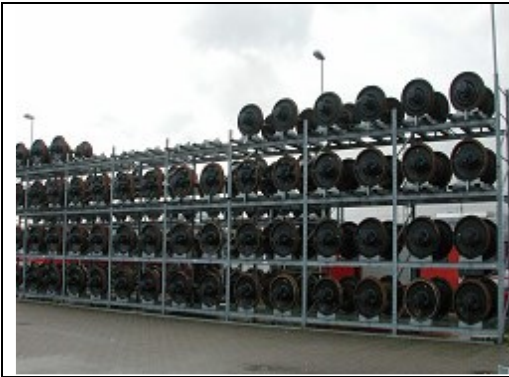
Bild 5: Gestapelte Lagerung mittels Ladegestell
