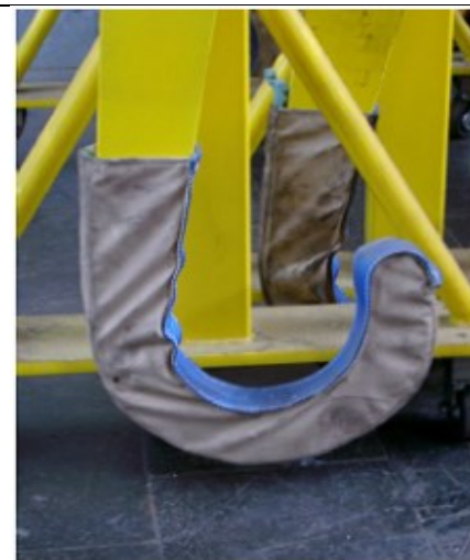
Bild 2: Kranhebestell für Radsätze, Schutz abnehmbar
