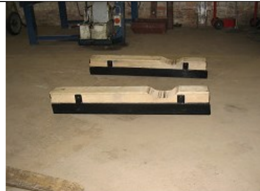
Bild 6: Radsatzaufnahme für Gabelstapler
