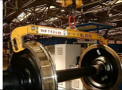
Bild 4: Radsatzaufnahme für Gabelstapler
