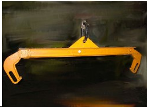
Bild 3: Kranhebestell für Radsätze (Radscheibe)
