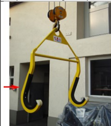
Bild 1: Kranhebestell für Radsätze (Radsatzwelle)
