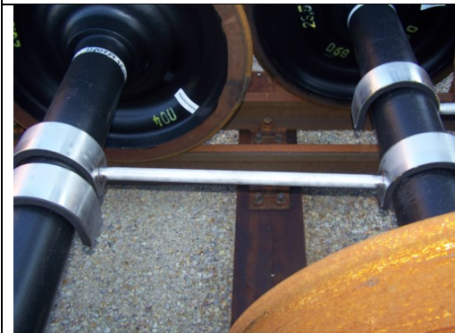
Bild 7: Versetzte Lagerung im Doppelgleis mittels Abstandhaltern
