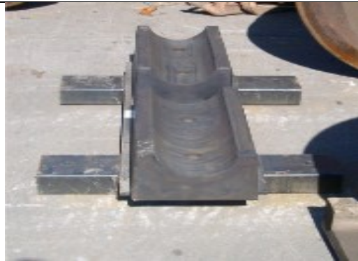
Bild 5: Radsatzaufnahme für Gabelstapler
